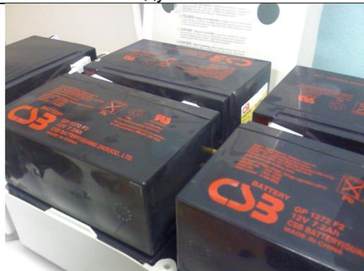
Деформированные аккумуляторы внутри модуля аккумулятора.
